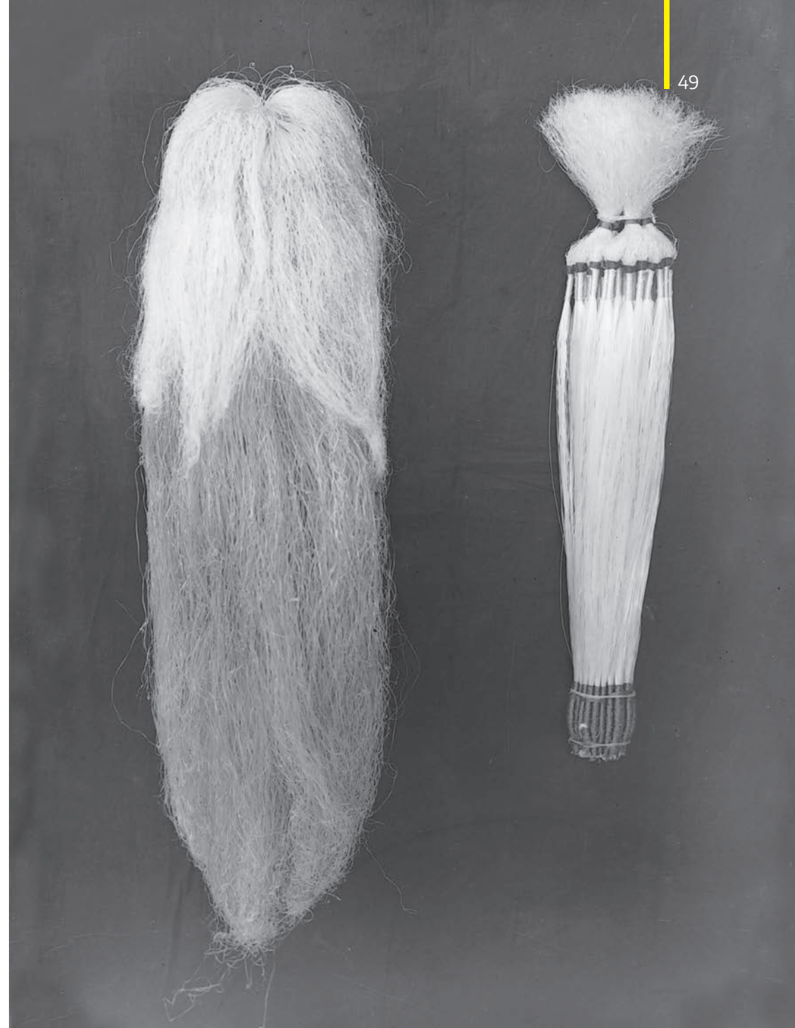
Moña de hijuela (izquierda) formada por unas dos mil fibras sin tratamiento industrial. Mazo de hijuela (derecha) tras someter las fibras a distintos procedimientos industriales.
