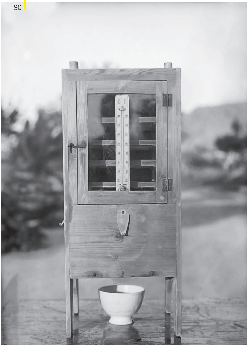
Incubadoras modelo Estación Sericícola, con distintos recipientes inferiores para mantener la temperatura.
