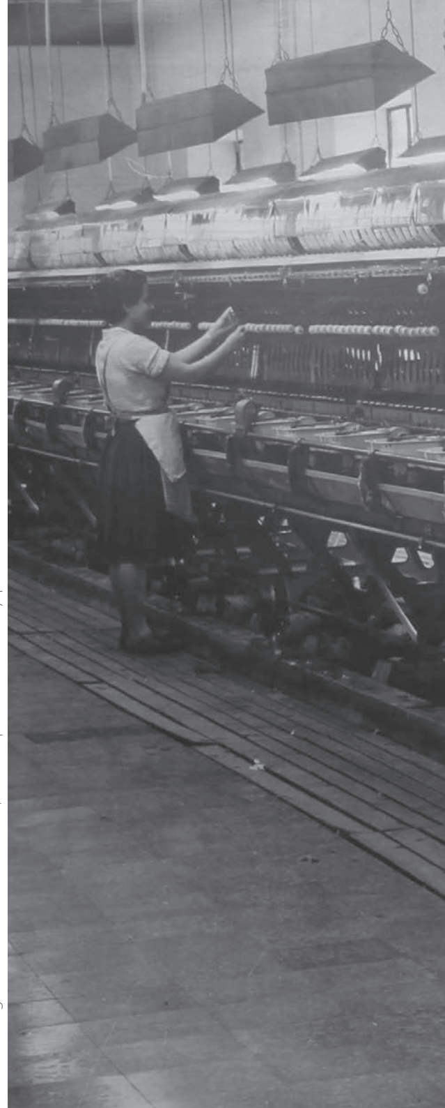
Imagen de una fábrica de seda, con máquina automática japonesa «TAMA».
