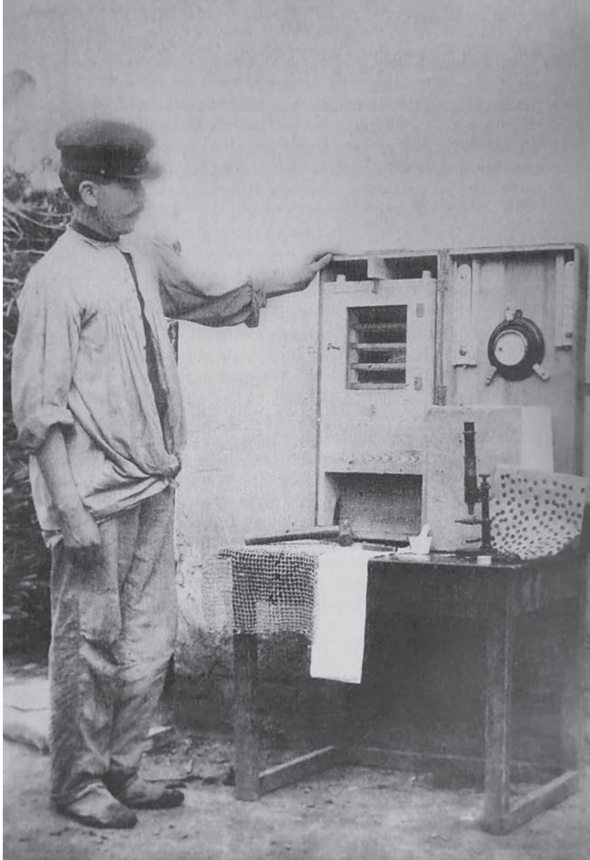
Escuela práctica de sericultura compuesta por: un obrero de la Estación y un baúl que contenía una incubadora completa, un higrómetro, dos termómetros (uno para la incubadora y otro para el obrador), un cuadernillo de papel de estraza con dos sacabocados y un martillo, una red de bramante, un microscopio con sus accesorios, un mortero de porcelana, 10 cristales porta objetos y 25 cubre objetos, dos trapos de limpieza y una libreta de inspección de crianzas (en la que se debían anotarse todos los detalles de la misma, incluyendo un registro diario de las condiciones ambientales en el obrador).
