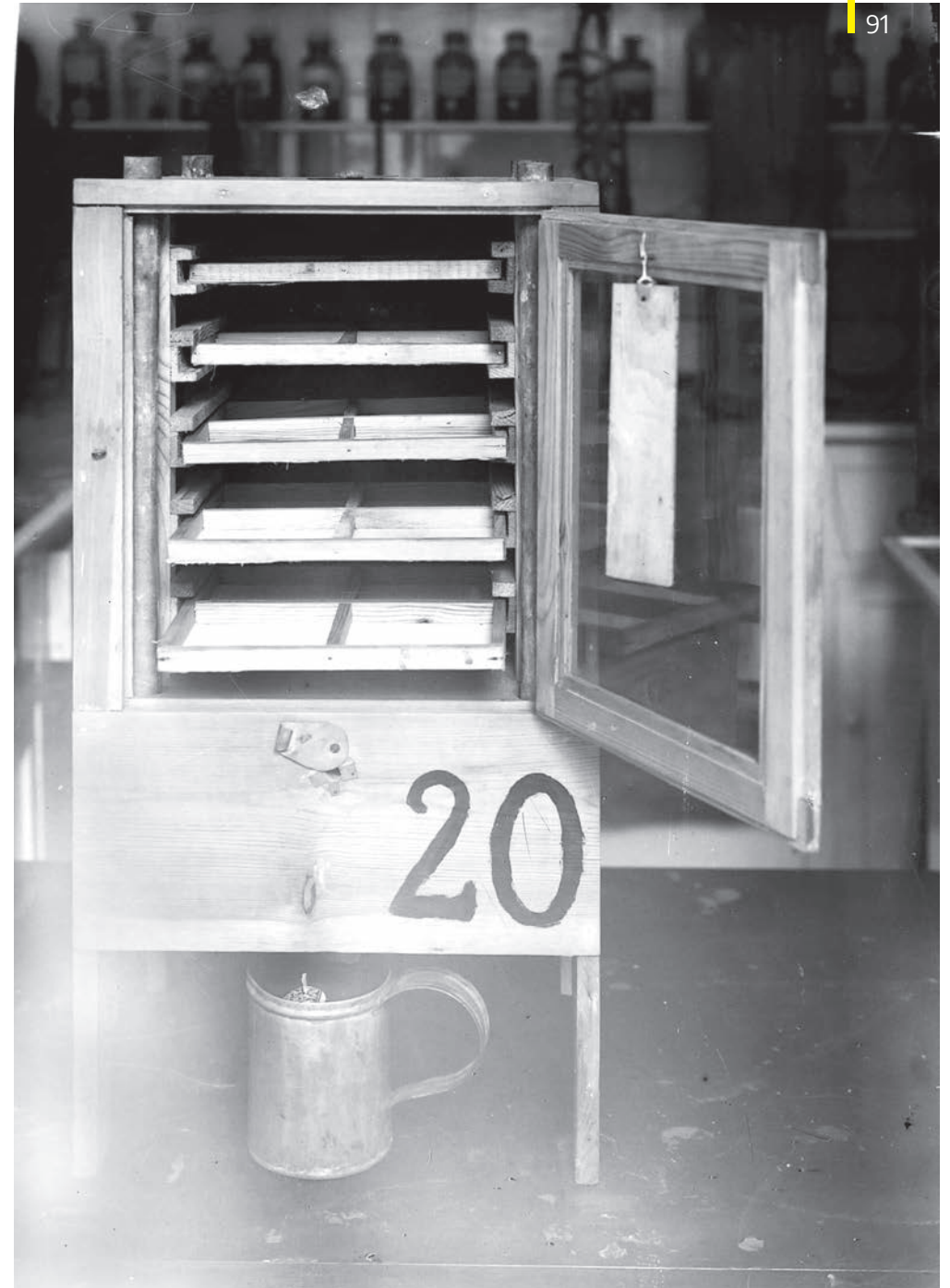
Incubadora modelo Estación Sericícola abierta, con vista de los zarcos interiores.
