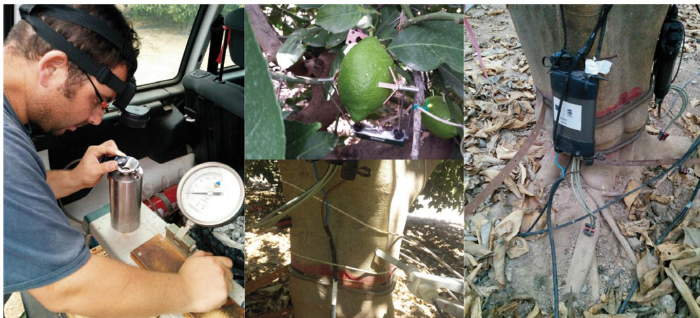
**Foto 2** Medida del potencial hídrico de tallo con cámara de presión (izquierda). Sensores para determinar las fluctuaciones del crecimiento de fruto y tronco (centro). Sensor de medida de flujo de savia (derecha)
