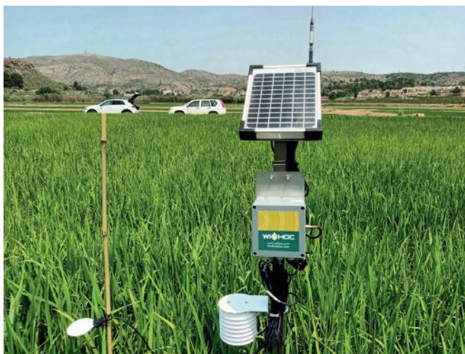
Figura 5. Instalación de Estación a pie de campo.
